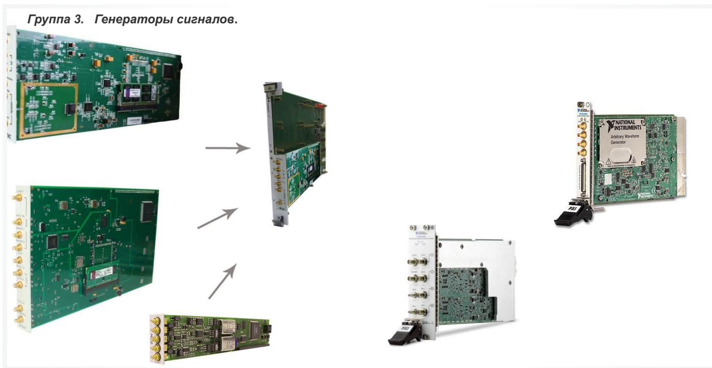
Рис.3 Генераторы МГКС, МГВЧ, МГВ2 от Информтест. Генераторы PXIe 5451, PXI 5422 от National Instruments.
