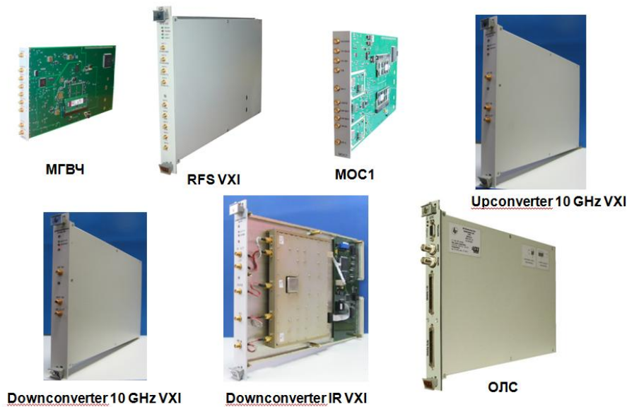
Рис.1. Модульные приборы в открытых стандартах VXI и LXI производства холдинга «Информтест»
