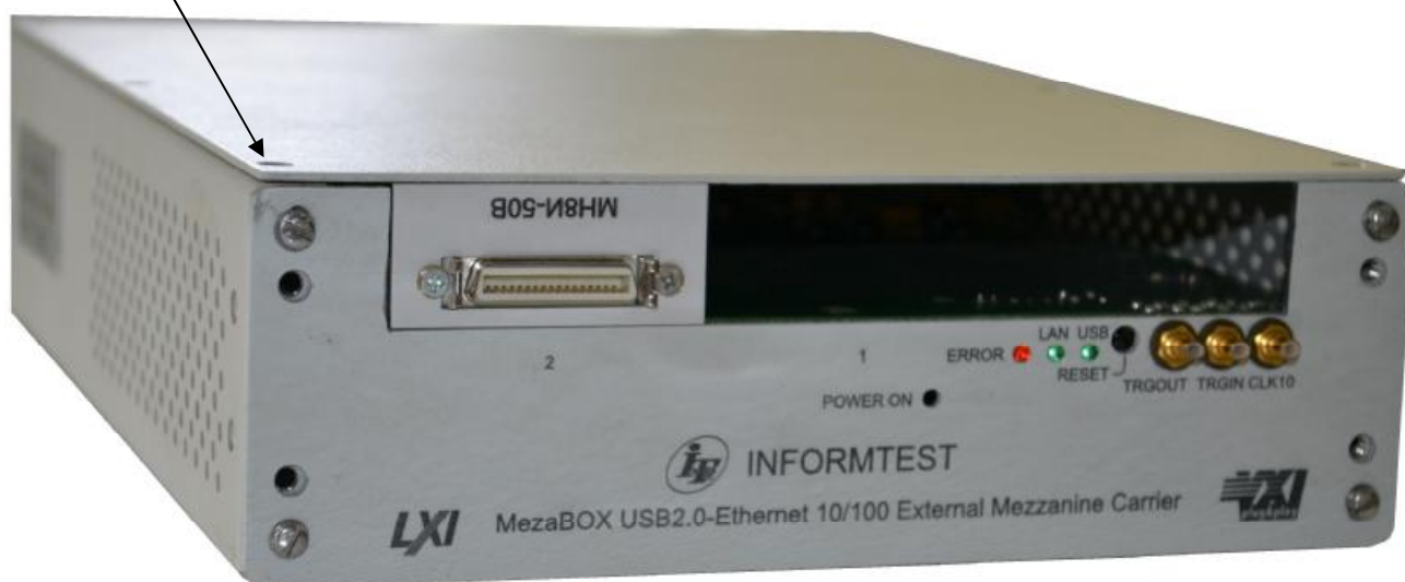
Рисунок 4 - Внешний вид устройства MezaBox ФТКС.469133.006 с установленным измерителем
