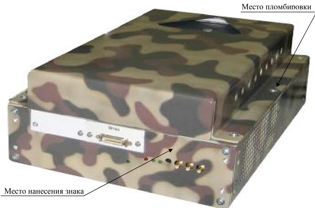
Рисунок 2 – Внешний вид устройства MezaBox\Battery 133W-hrs с установленным измерителем, указанием места нанесения знака утверждения типа и местом пломбировки
