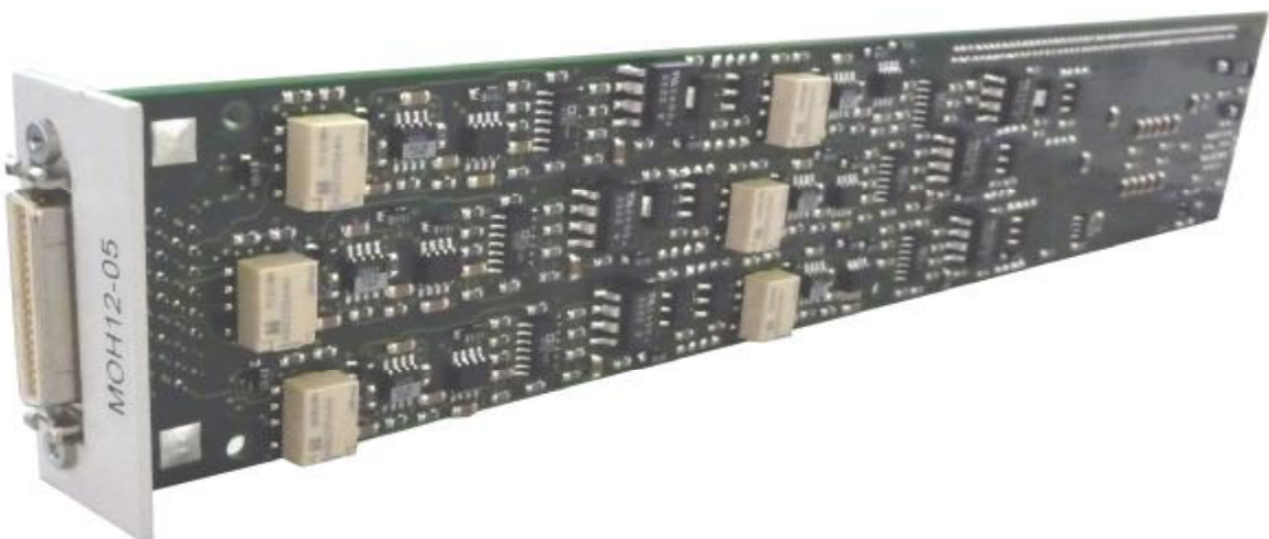
Рисунок 9 – Внешний вид источника напряжения постоянного тока MOH12-05 ФТКС.468266.020-05
