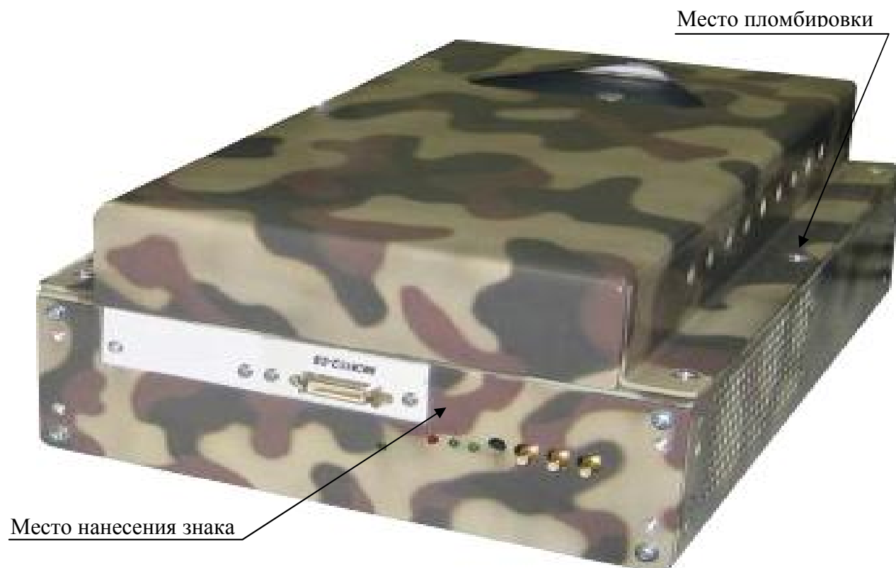
Рисунок 2 – Внешний вид устройства MezaBox\Battery 133W-hrs с установленным источником напряжения постоянного тока, указанием места нанесения знака утверждения типа и местом пломбировки
